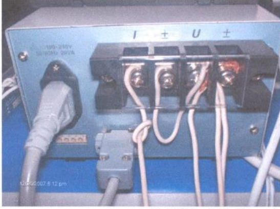
Şekil 8. Güçölçer besleme yük arasında bağlanma şekli.
