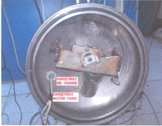
Şekil 2. Kalorimetre Kazanı Dış Kapak içten görünüş, karıştırıcı düzeneği.
