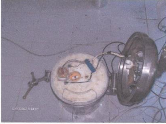
Şekil 4. Kalorimetre kazanı genel görünüş, kapak açık
